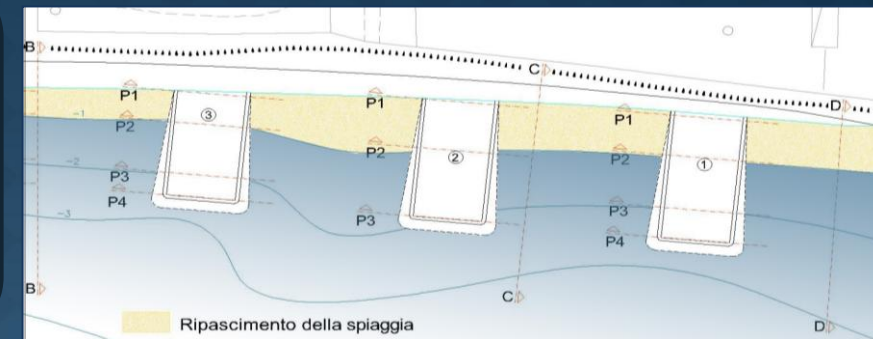
Intervento di ripascimento della spiaggia
